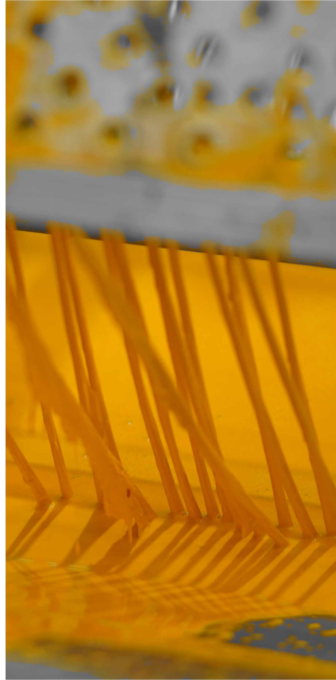
2. Después, las fibras son saturadas con la mezcla de la resina, proceso en el cual las fibras se impregnan.
